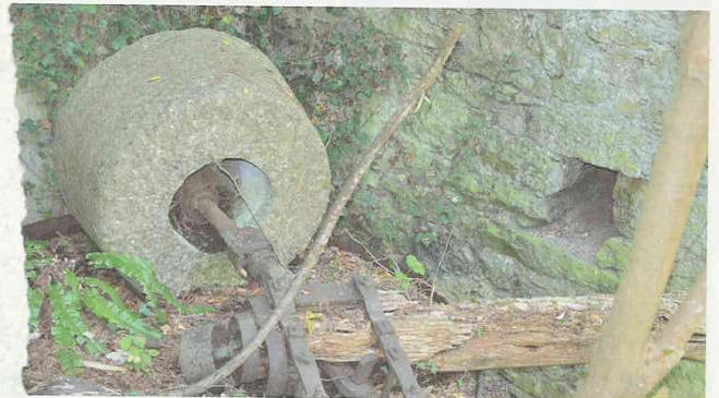
Moulin de Salauz. Niveau inférieur de l'atelier principal de l'huilerie : conche en pierre, équipée de sa meule, du bras d'entraînement et de l'arbre vertical permettant la rotation du sous ensemble assurant le 1er stade de fabrication. Collection Association Au Cœur des Gorges du Sierroz.
